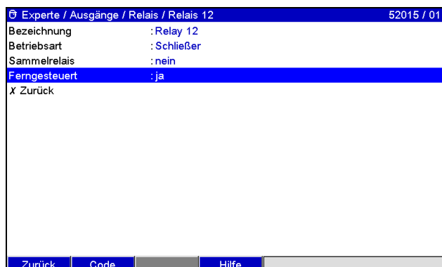
Abb. 6: Setup - Ausgänge - Relais - Relais x - Ferngesteuert
