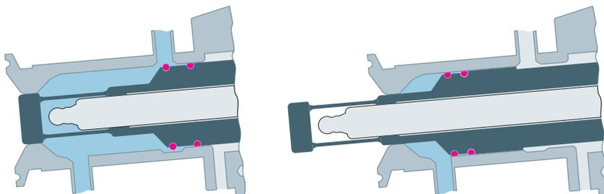
Die Dichtung zwischen dem sterilen und nicht sterilen Bereich bewegt sich dynamisch mit – vergleichbar mit einer Spritze. Dadurch kommen zu keiner Zeit kontaminierte Flächen mit Sterilraum oder Medium in Berührung. Ein Eindringen von Keimen ist so unmöglich.
