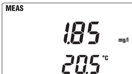
Bild 5.1 Das Display nach dem Einschalten und abgeschlossenem Selbsttest
