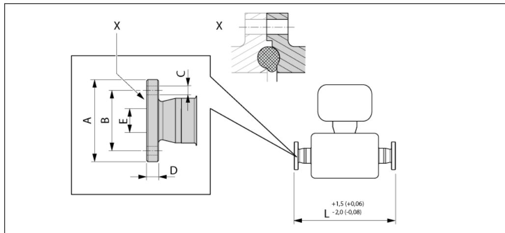
39 Деталь X: асимметричное присоединение к процессу, деталь, обозначенная серым цветом, предоставляется поставщиком. Единица измерения (мм)
