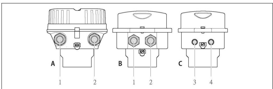
A Исполнение корпуса: компактное, с алюминиевым покрытием
