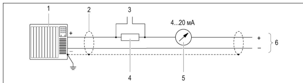
8 Пример подключения для активного токового выхода 4...20 mA HART
