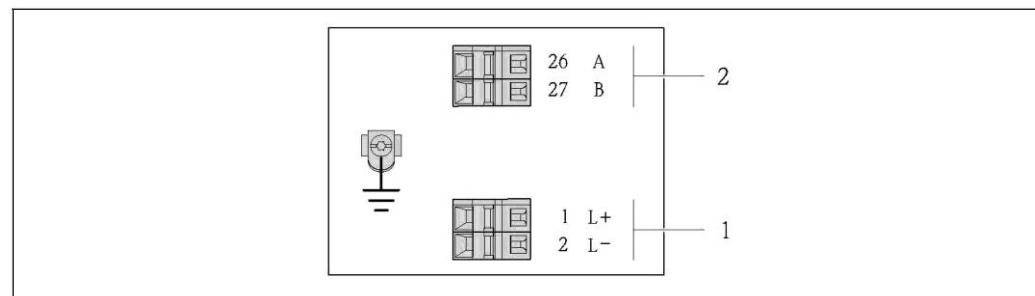
3 Назначение контактов PROFIBUS DP, исполнение с для использования в безопасных зонах и зоне 2/разд. 2
