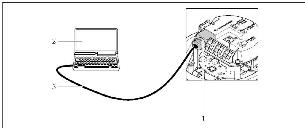
48 Подключение для кода заказа для выходного сигнала, опция B: 4...20 mA HART, импульсный/частотный/релейный выход
