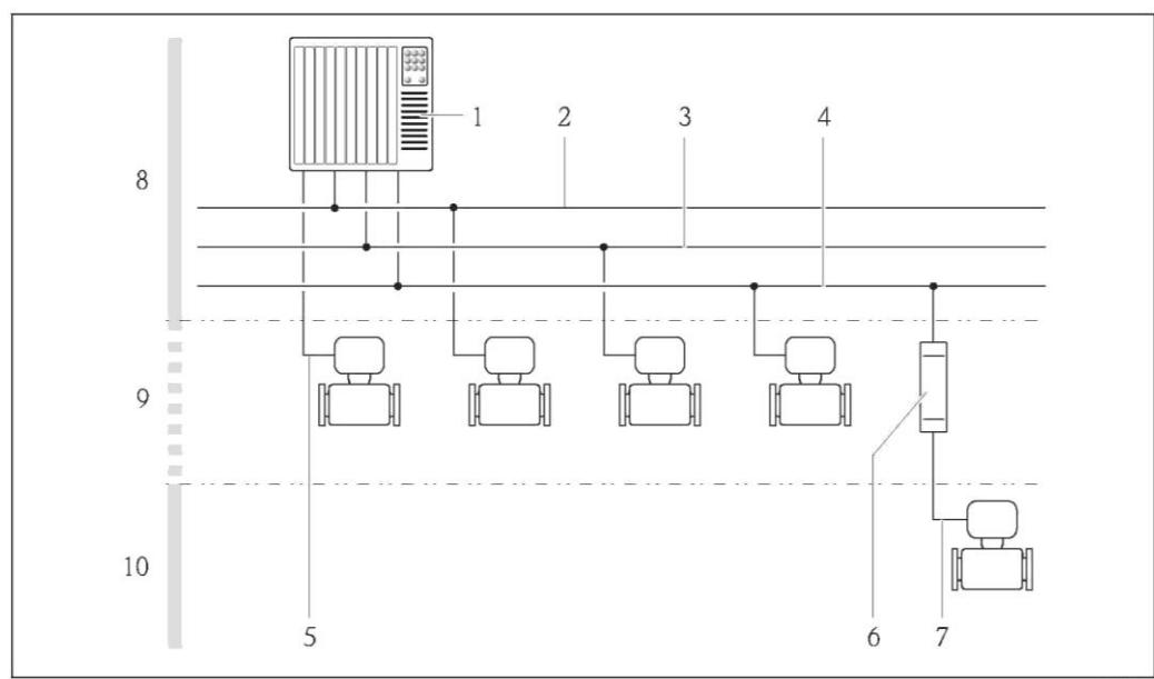
**■ 1 Возможности интеграции измерительных приборов в систему**
