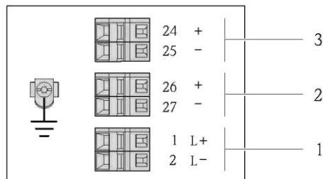
2 Назначение контактов: 4...20 mA HART с импульсным/частотным/релейным выходом
