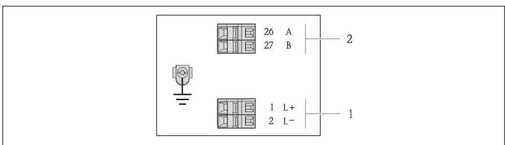
4 Назначение контактов Modbus RS485, исполнение с подключением PROFIBUS DP для использования в безопасных зонах и зонах 2. 2
