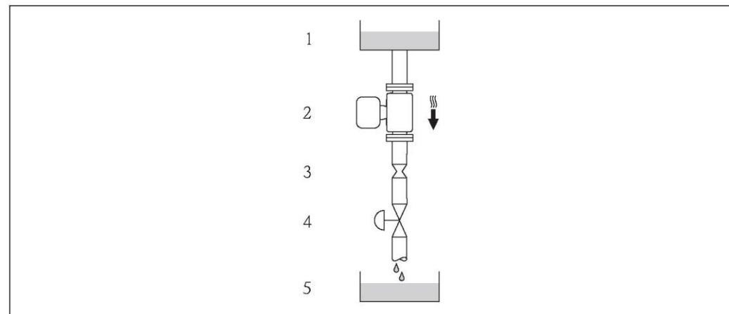
■ 18 Монтаж на спускной трубе (например, для дозирования)
