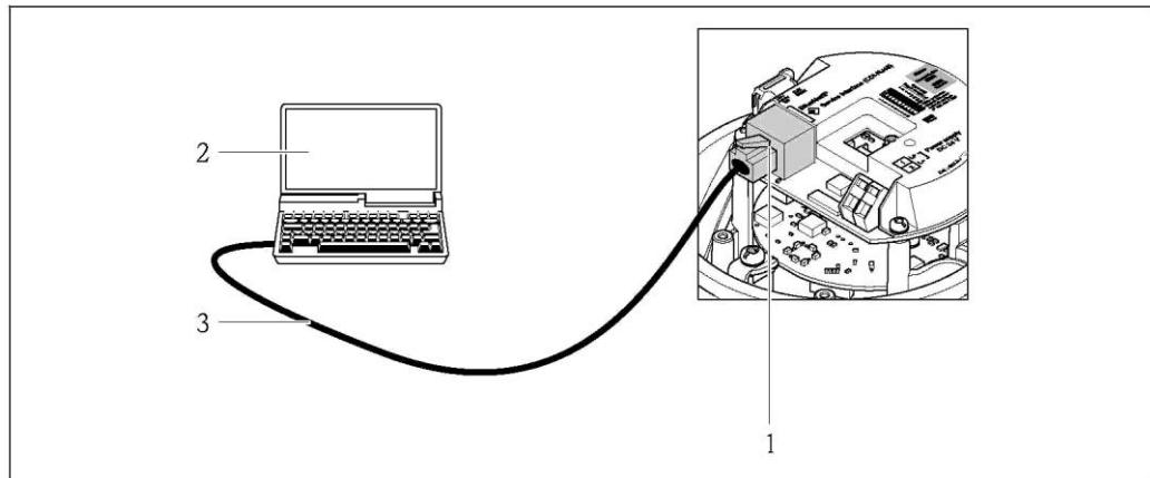
50 Подключение для кода заказа для выходного сигнала, опция N: EtherNet/IP
