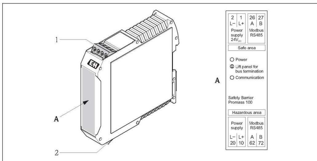
7 Предохранитель Promass 100 с клеммами
