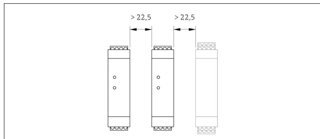
21 Минимальное расстояние до дополнительного искрозащитного барьера Promass 100 или других модулей. Единица измерения (мм)
