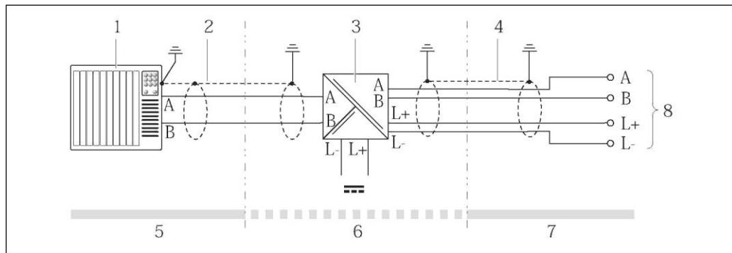
13 Пример подключения для искробезопасного интерфейса Modbus RS485
