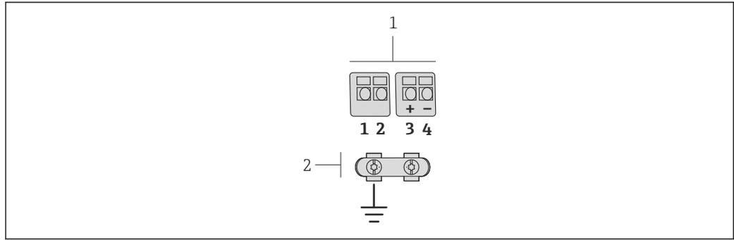
図 10 センサ接続ハウジングおよび変換器壁ホルダーの端子部の端子
