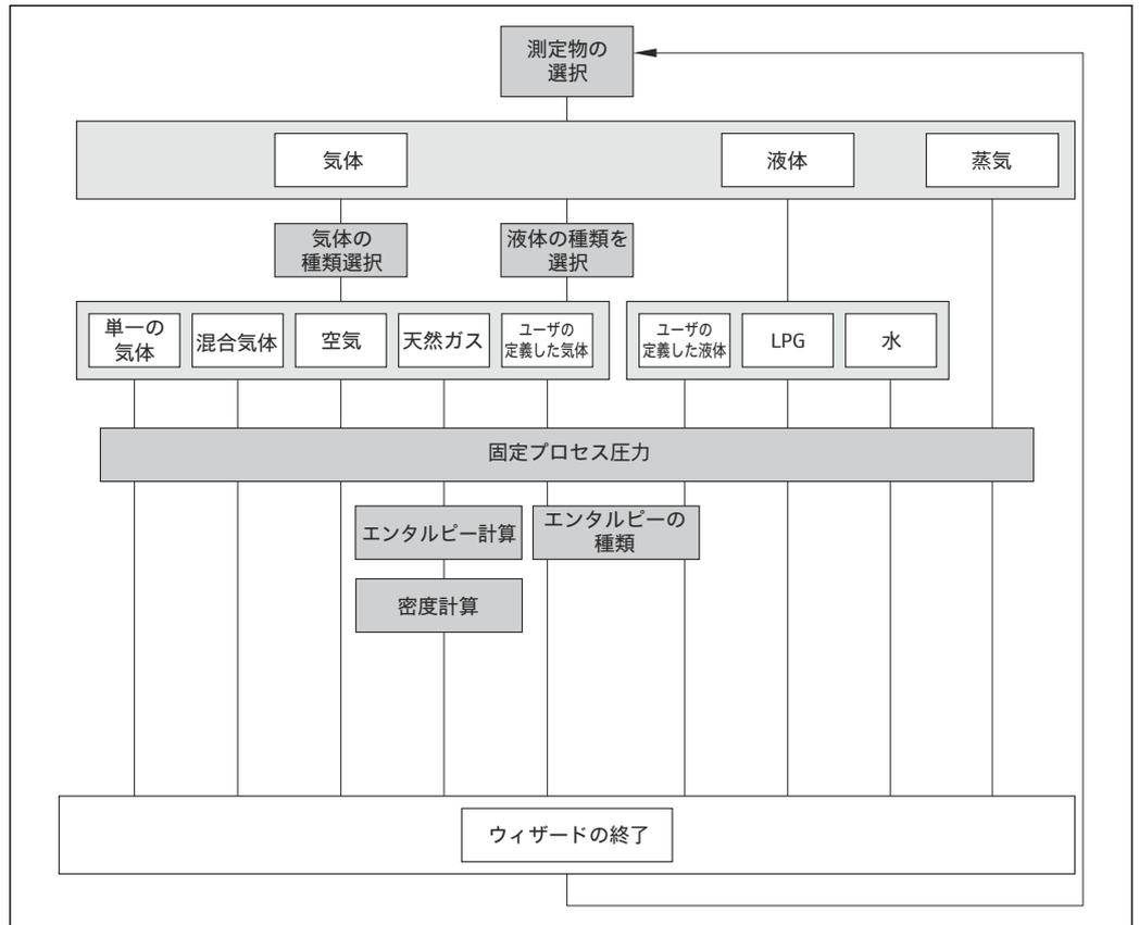
図 19 「流体の選択」ウィザード、「設定」メニュー
