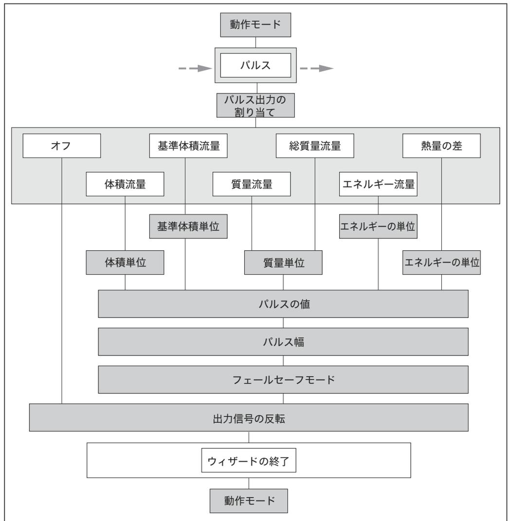
図 21 「設定」メニュー：「パルス」動作モードの「パルス/周波数/スイッチ出力」ウィザード
