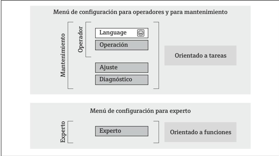
16 Estructura esquemática del menú de configuración
