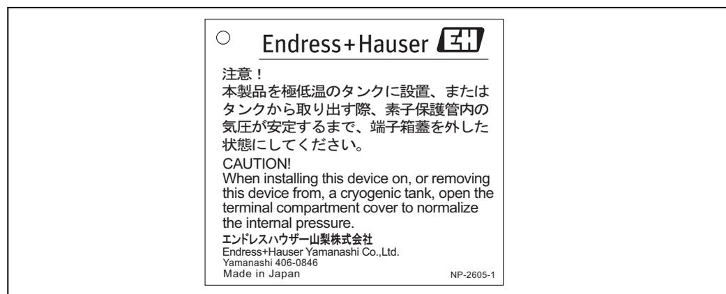
Figure 21 : Plaque d'avertissement  $-170\text{ }^{\circ}\text{C}$
