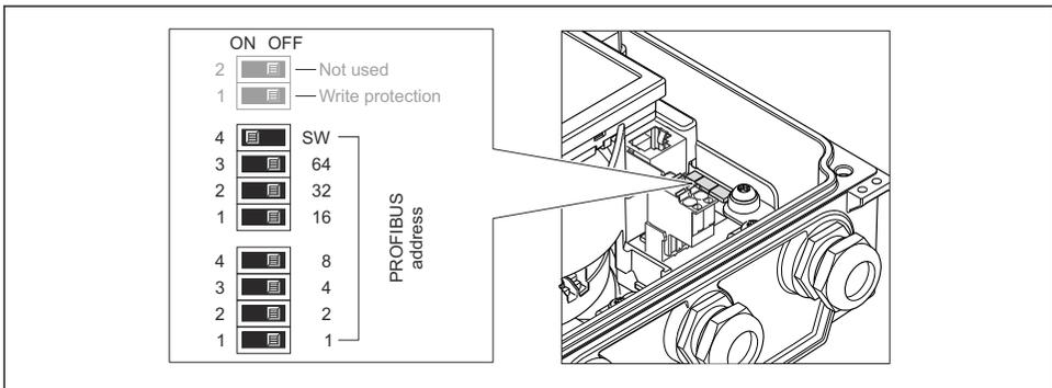
12 Adressierung mit Hilfe von DIP-Schaltern auf dem I/O-Elektronikmodul
