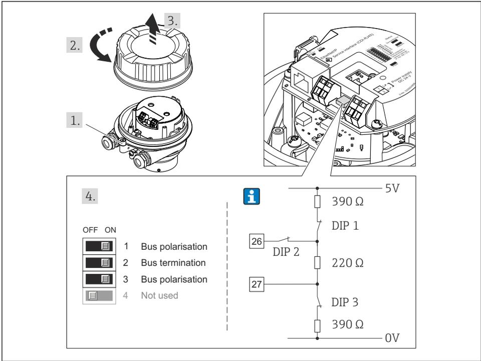
11 Terminierung mit Hilfe von DIP-Schaltern auf dem I/O-Elektronikmodul einstellen (bei Baudraten < 1,5 Mbaud)
