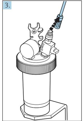
▶ Schlauchkupplung lösen
