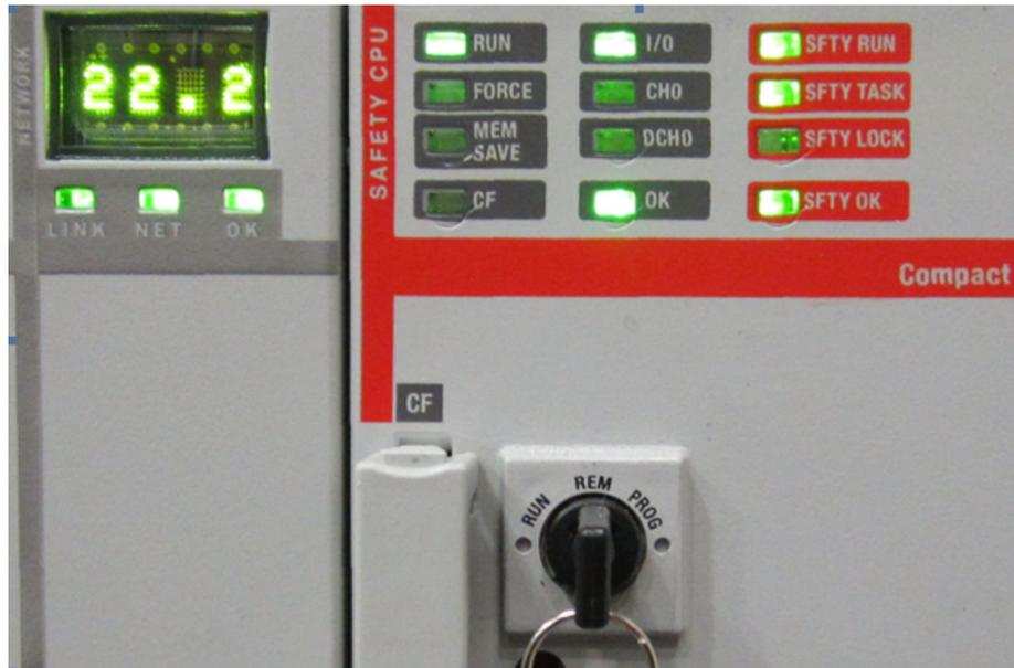
Zu allen unten aufgeführten Statusanzeigen muss die grüne Leuchte eingeschaltet sein und der Schlüsselschalter in der Position RUN stehen, um zu bestätigen, dass alle Sicherheitsbedingungen erfüllt sind.
