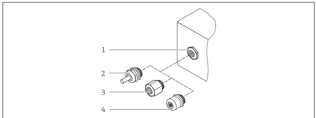
28 Mögliche Kabeleinführungen/-verschraubungen
