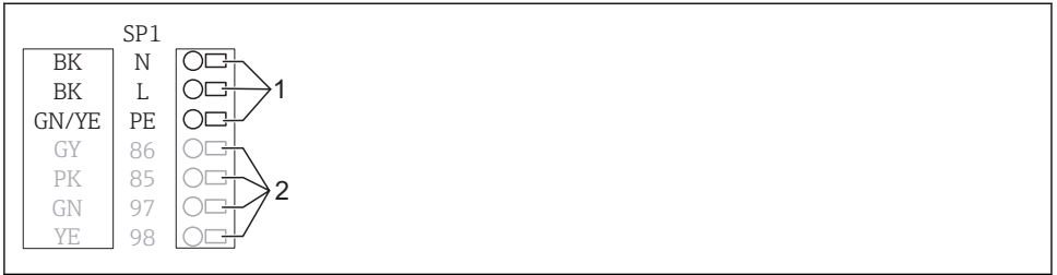
图 8 Liquiline System CA80 中清洗阀的接线图
