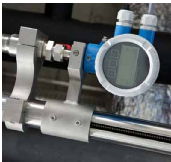
Auswechselarmatur („Hot tap“) für das Einsetzen/Entfernen des Messaufnehmers unter Prozessbedingungen
