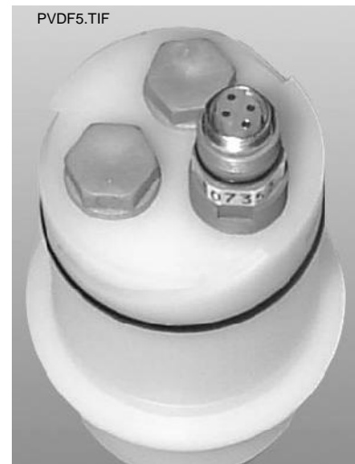
Uchwyt z zamocowan elektrod (niewykorzystane miejsca za lepione)
