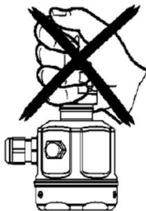
Poser tête de capteur vers le bas. Un choc sur le capteur peut le détériorer.
