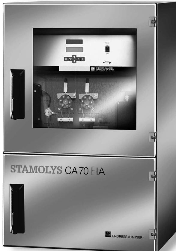
Der Stamolys Analysator CA 70 HA ist ein kompaktes Analysesystem zur Bestimmung der Gesamthärte anhand von Calciumkarbonat zum Einsatz in Trinkwasseranlagen. Die Bestimmung der Gesamthärte erfolgt nach dem photometrischen Messprinzip.
