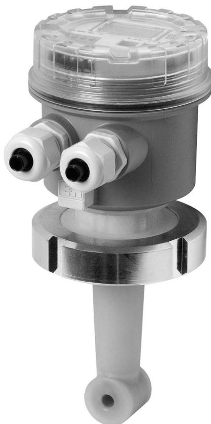
Der kompakte Messumformer SmarTec M CLD 133 dient zur induktiven Leitfähigkeitsmessung in Flüssigkeiten mittlerer bis hoher Leitfähigkeit, wie z.B. zur Steuerung und Überwachung bei der CIP-Reinigung. Der Messumformer kann in Temperaturbereichen bis 100 °C eingesetzt werden.
