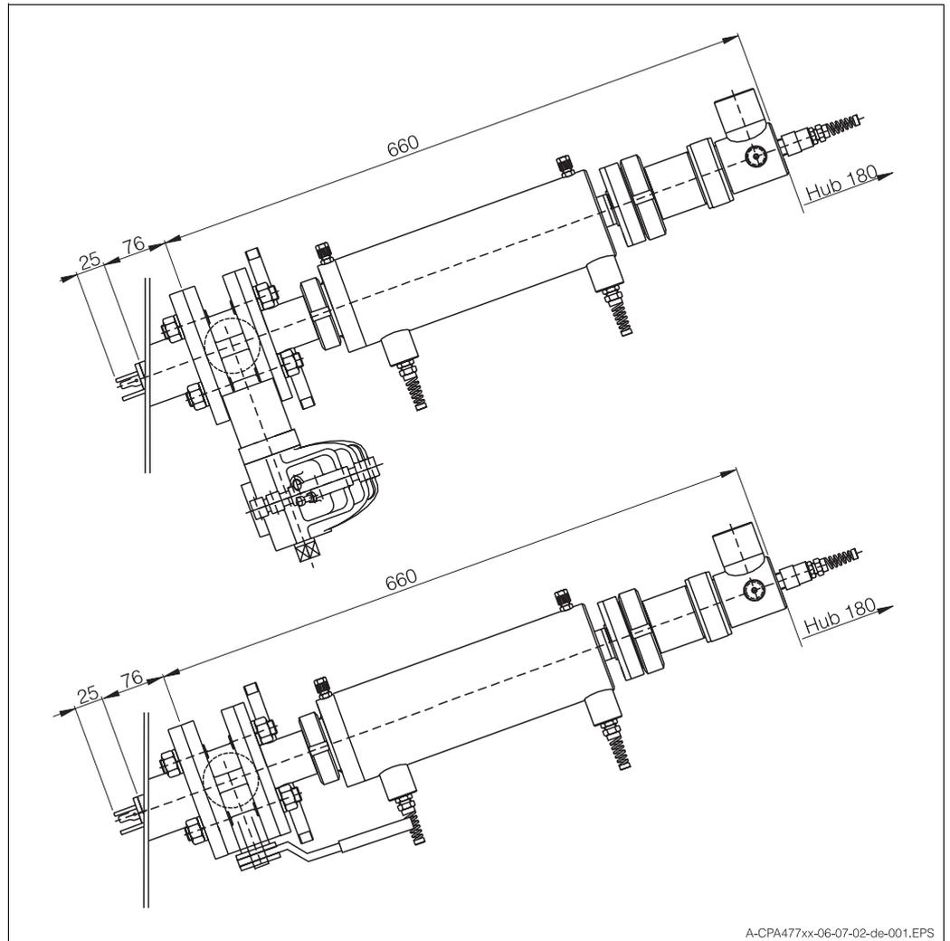
oben: CleanFit P CPA 477 mit pneumatischem Kugelhahntrieb in Messposition
