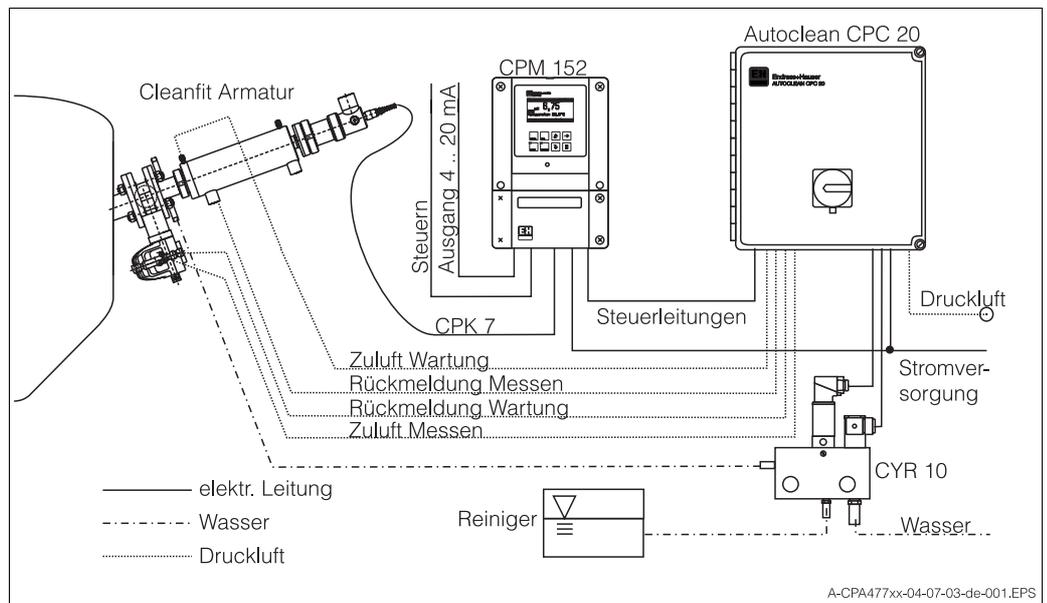
Übersicht der Anschlüsse an die zwangsgesteuerte Armatur CleanFit P CPA 477
