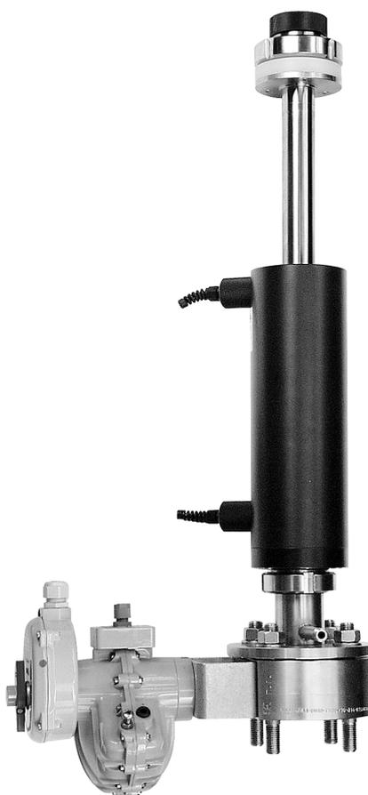
Diese Wechselarmatur erlaubt das automatische Reinigen, Kalibrieren und Austauschen der Elektrode bei vollem Behälter oder unter Prozessbedingungen bis 6 bar Druck.
