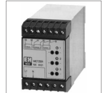
Face avant de l'alimentation de transmetteur NX 9121 à 3 voies avec occupations des bornes (bornes 3 à 7 non occupées)
