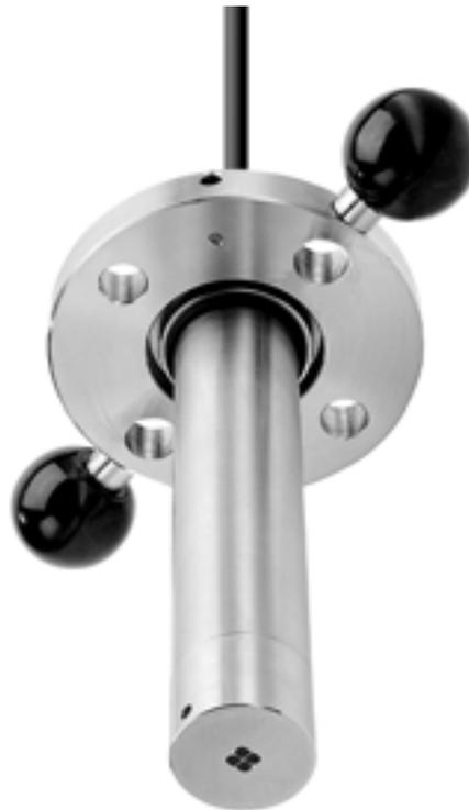
Der Sensor TurbiMax P CUS 64 dient zur optischen Feststoffgehaltsmessung in Trübwasser bis 150 g Feststoff/l für Anwendungen in Ex-Bereichen.
