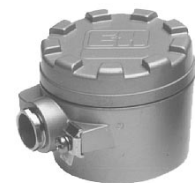
A Aluminiumgehäuse mit Standard-Kabeldurch- führung Pg 16, Schutzart IP 55
