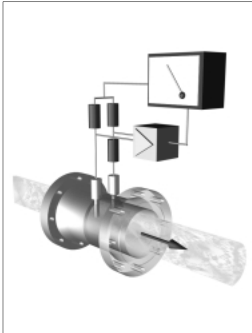
Rys.1 Zasada pomiaru termicznego
