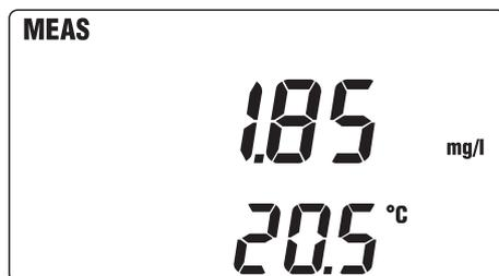
A la mise sous tension, le transmetteur procède à une routine de contrôle, puis passe en mode de mesure..
