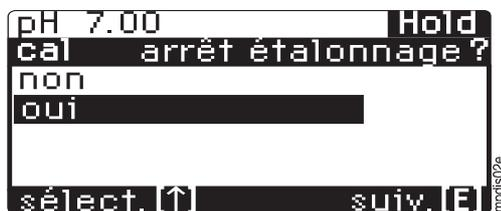
Si la routine est interrompue avec l'option "oui, interrompre cal.", l'appareil revient au mode de mesure. Si la réponse est "non", l'étalonnage est poursuivi.
