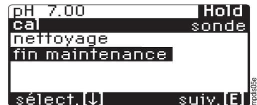
Ces fenêtres sont affichées si le système utilise une sonde rétractable. L'état de la sonde et du nettoyage sont affichés dans une fenêtre d'informations.
