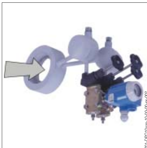
Diaphragme monobloc Deltatop DPO 10 Application : vapeur, conduite horizontale, montage à droite
