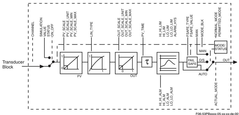
le bloc fonctions Analog Input obtient sa valeur d'entrée du bloc Transducer.
