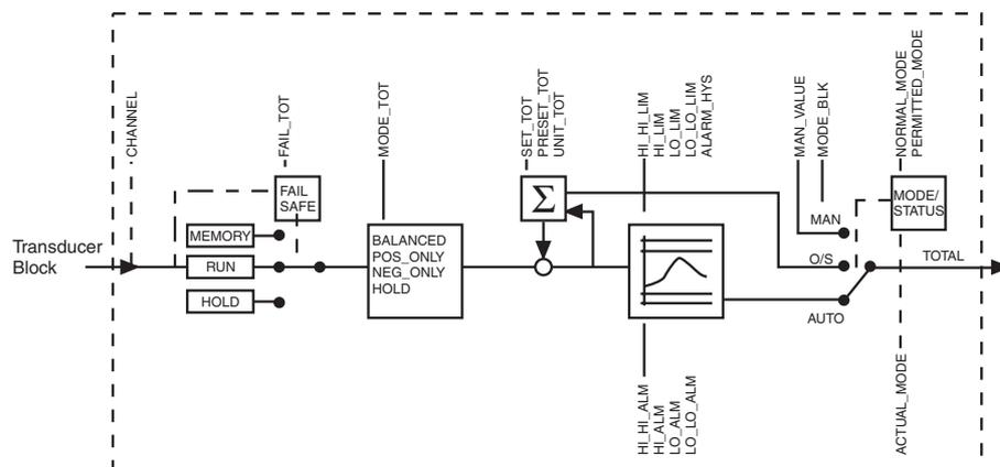
Le bloc fonctions Totalizer obtient sa valeur d'entrée (grandeur de mesure débit massique) du bloc Transducer.
