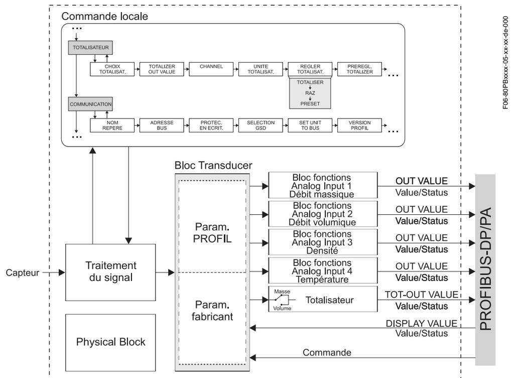
Le signal capteur est tout d'abord préparé spécifiquement pour le débit dans le bloc technique, le bloc Transducer. Puis la grandeur process est transmise aux blocs Analog Input et Totalizer pour traitement (par ex. mise à l'échelle, exploitation de la valeur de seuil). Les grandeurs de process sont soumises à l'ensemble de l'algorithme du bloc fonctions et sont alors disponibles comme grandeurs de sortie.
