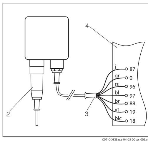
Fig. 16 : Boîte de jonction VS pour appareil encastrable
