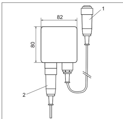
Fig. 15 : Boîte de jonction VS pour appareil de terrain
