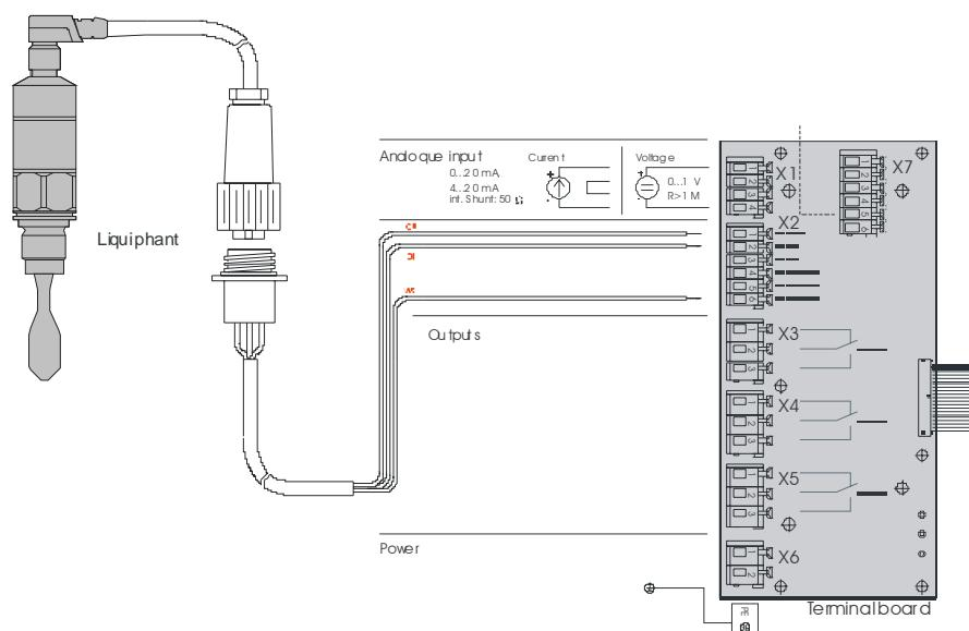
Alternative Abschaltung wie abgebildet an der Klemmenplatine der ASP Station 2000 anschließen.
