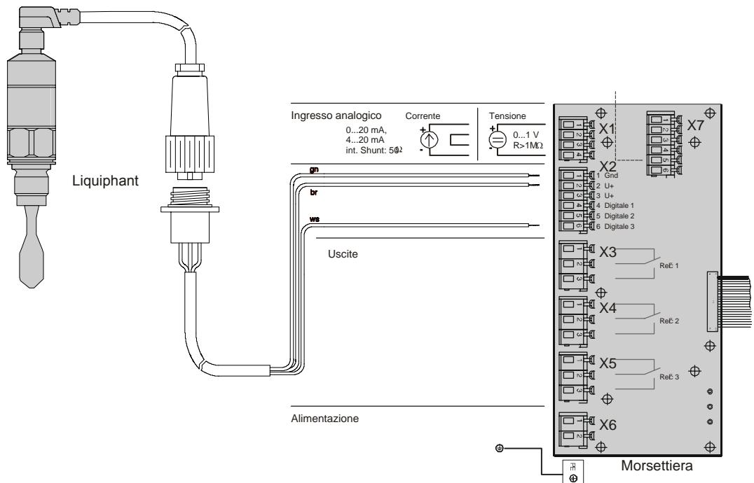
Il sensore capacitivo/Liquiphant deve essere collegato alla morsettiera dell'ASP Station 2000 come mostrato nell'illustrazione qui sopra.
