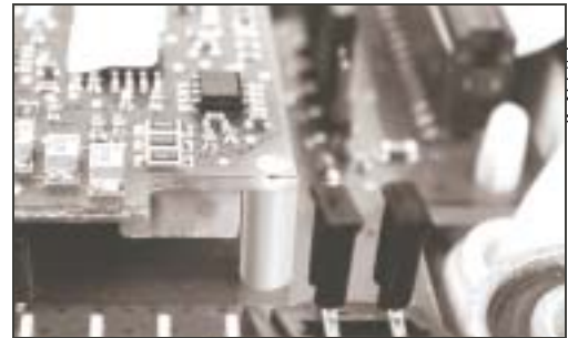
Fig. 23: Ponticello per la connessione del sensore IsFET TopHit H CPS 471
