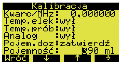
Rys. 28: Kalibracja pojemności próbki dla poboru próbek proporcjonalnego do przepływu
