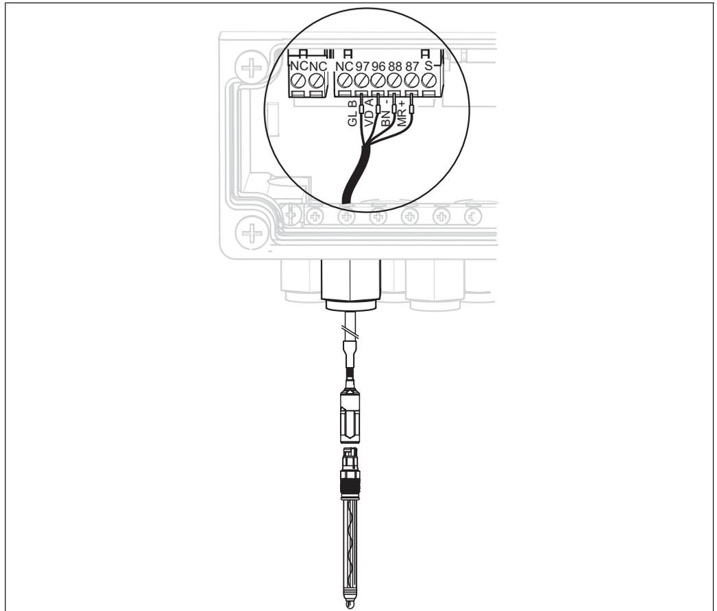
Fig. 31: Connessione dei sensori digitali con tecnologia Memosens
