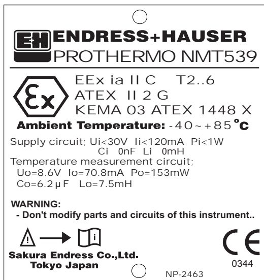
Рис. 1 Информация на паспортной табличке Prothermo NMT 539 с аттестацией ATEX, модель "Только преобразователь".
