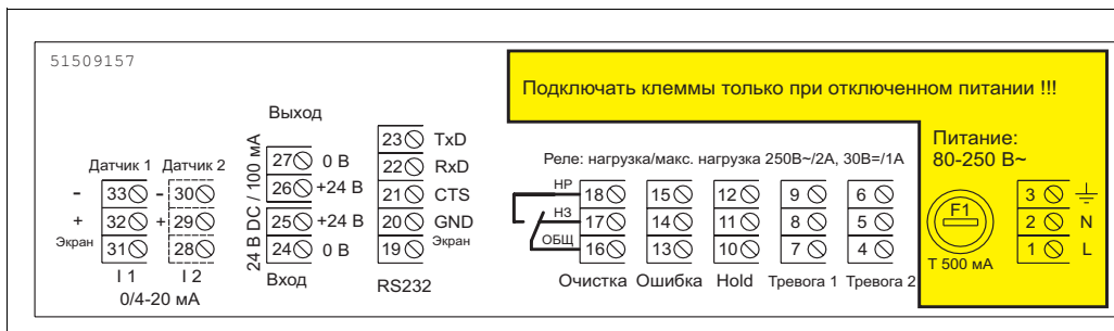
Рис. 16: Электрическое подключение преобразователя с питанием 80 ... 250 В AC
