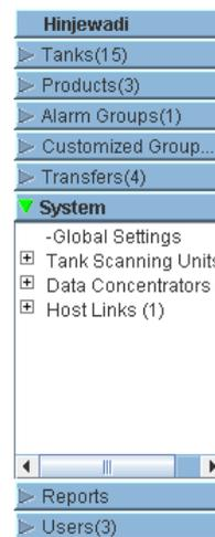
2. La figure ci-dessus montre le < sous-système Tankvision >, à savoir les Tank Scanners (NXA820), les Data Concentrators (NXA821) et les Host Links (NXA822). Les Tank Scanners, les Data Concentrators et les Host Links comprennent respectivement toutes les unités NXA820, NXA821 et NXA822 dans ce réseau.
