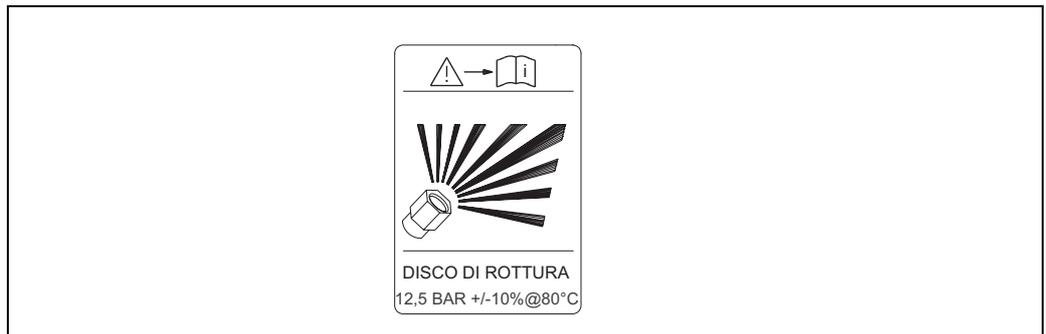
Etichetta di indicazione per il disco di rottura
