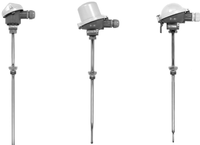
I sensori di temperatura TC 10 Omnigrad M sono termocoppie progettate per i processi della chimica fine, ma sono adatti anche per applicazioni generiche. Sono costituiti da una sonda di misura con pozzetto termometrico e da una custodia, che può contenere il trasmettitore per la conversione della variabile misurata. Grazie alla sua configurazione modulare e alla struttura secondo lo standard DIN 43772 (form 2G/3G), il termometro TC 10 è impiegato in quasi tutti i processi industriali.
