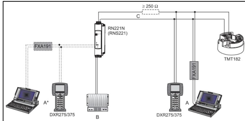
A = Anschluss HART® -Kommunikation auf 4 bis 20 mA Leitung
