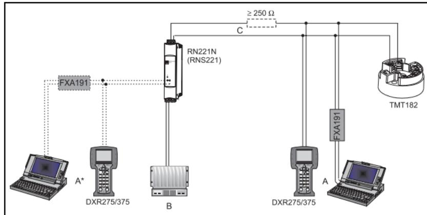
A = Raccordement communication HART® sur 4 à 20 mA fils
