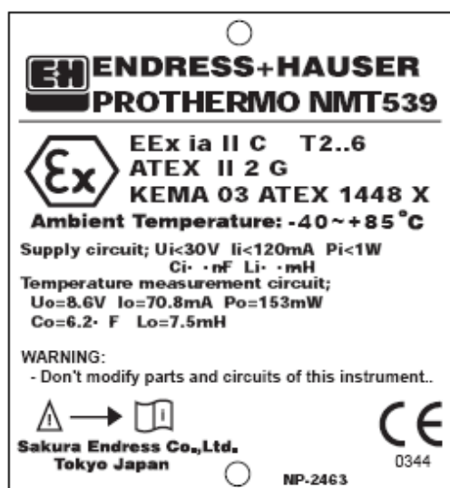
Fig. 1: Exemplo de informação da placa de identificação do Prothermo NMT 539 com aprovação ATEX, versão “Conversor apenas”.
