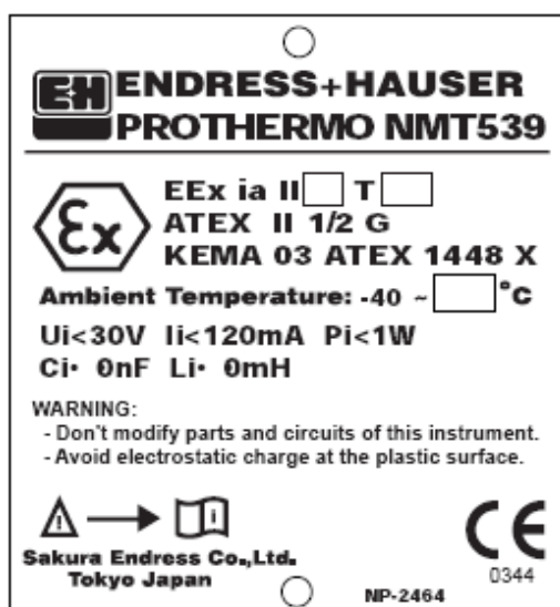
Fig. 2: Exemplo de informação da placa de identificação do Prothermo NMT 539 com aprovação ATEX.
