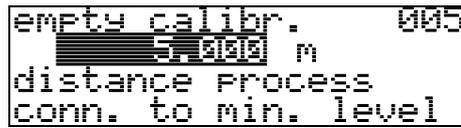
この機能は、フランジ面（測定基準点）から最低レベル (= 0%) までの距離を入力するために使用します。
