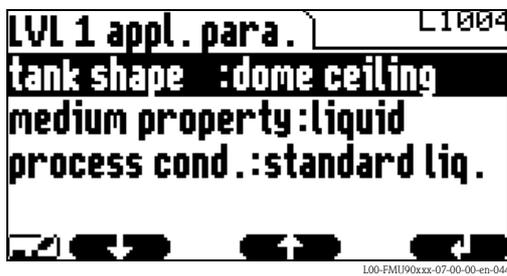
Se nell'angolo inferiore a sinistra del modulo display, viene visualizzato il simbolo
