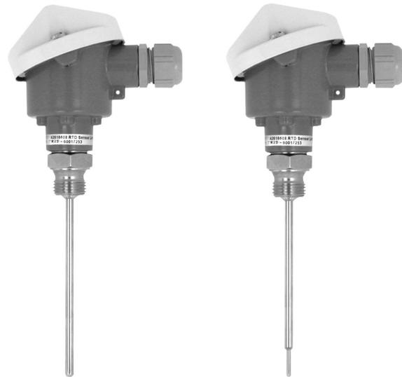
Die Widerstandsthermometer TR 25 der Serie Omnigrad T sind dank ihres modularen Aufbaus für nahezu alle industriellen Prozesse und allgemeinen Anwendungsbereiche geeignet. Sie bestehen aus einem Messfühler ohne Schutzrohr und einem Anschlusskopf, der den Transmitter für die Umformung des Messsignals aufnehmen kann.
