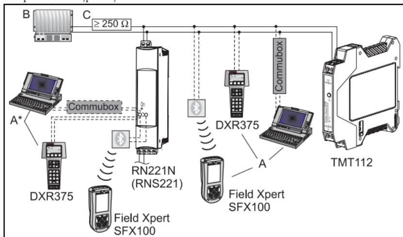
A = Raccordement communication HART® directement au transmetteur de température
