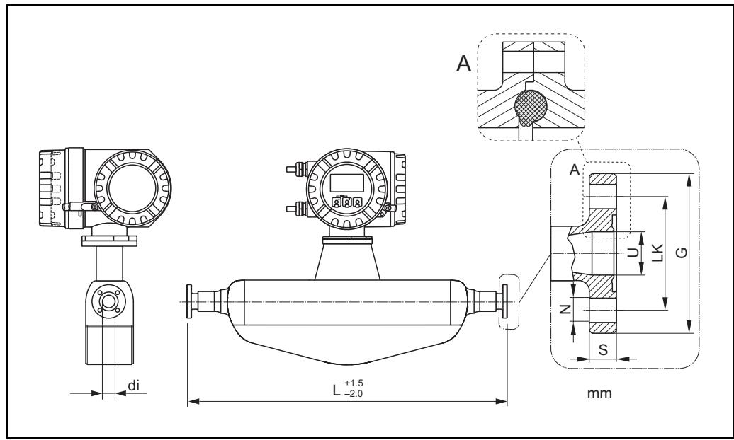
詳細図 A: フランジのセンサ側には、O リング用の小さめの溝が付いています。センサを取り付ける場合、相対するフランジには、O リングを受ける為のやや太めの溝が必要です。
