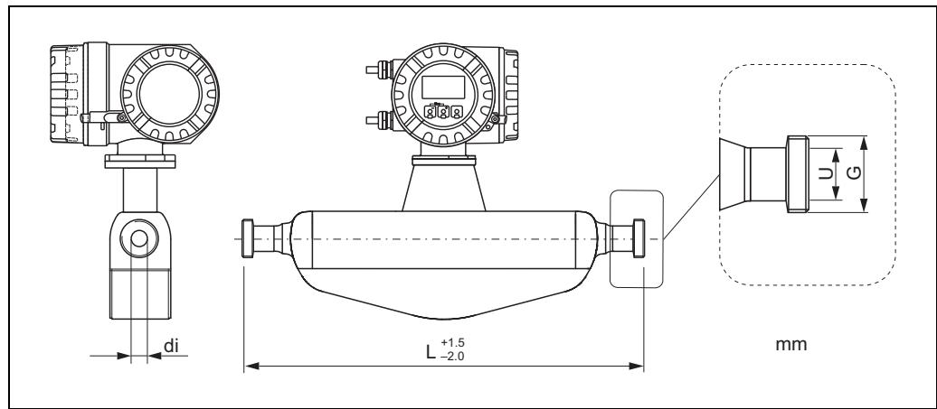
ハイジエニックカップリング DIN 11851: 1.4435/SUS 316L 相当 ( $Ra \leq 0.8 \mu\text{m}/150 \text{ grit}$ )
