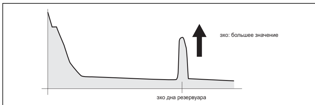
Рис. 6: Резервуар пустой, помех не наблюдается
