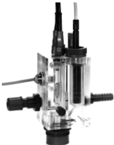
配管にやホースに取付けることができる、流通型ホルダです。電極先端は、ポット状のキャップに配置されているので、ラインを停止しても電極が乾くことがなく、安定した測定の再開ができます。
