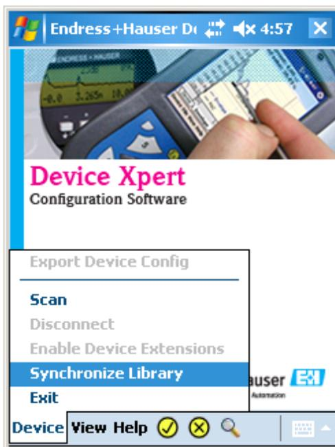
Fig. 6-10 : Screenshot - Mise à jour des DD dans Device Xpert
