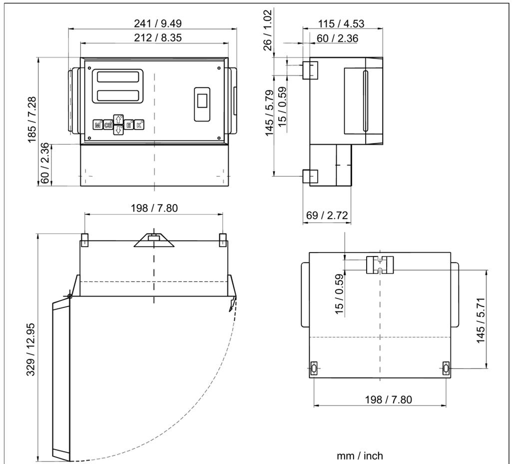
清洗单元(带空气压缩机)的机械尺寸
