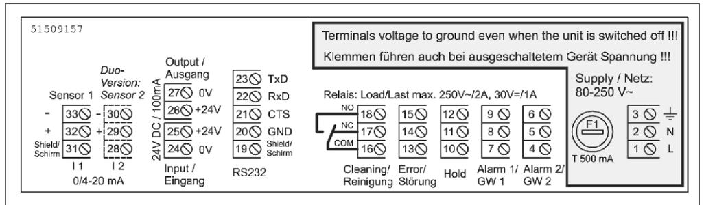
变送器的电气连接，供电电压24 V AC/DC
