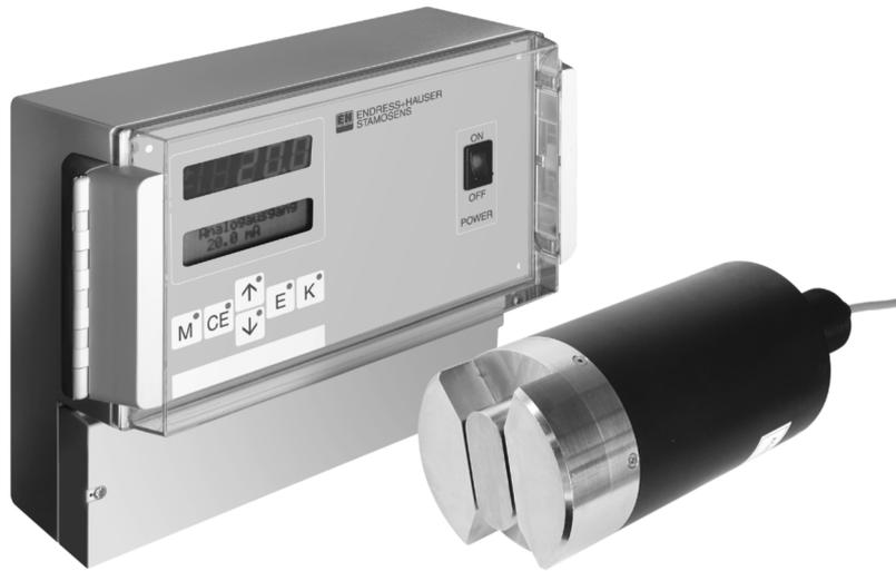
StamoSens CSM750变送器和CSS70传感器组成一个连续紫外吸收测量分析系统，用于监测污水处理厂尤其是出水口和曝气池中的有机物含量COD或BOD值。测量系统通过多光束的手段来补偿浊度、色度、悬浮物浓度等带来的干扰误差。
