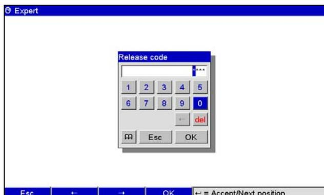
Fig. 23: Codice di sblocco per la configurazione Expert (impostazione di fabbrica: 0000)
