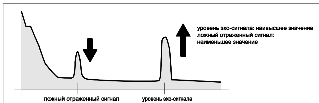
Резервуар частично заполнен, получен паразитный эхо-сигнал:
