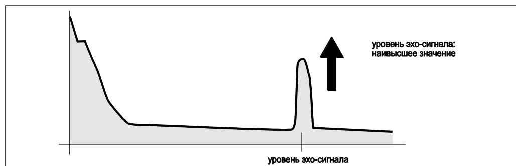
Резервуар частично заполнен, паразитный эхо-сигнал не получен
